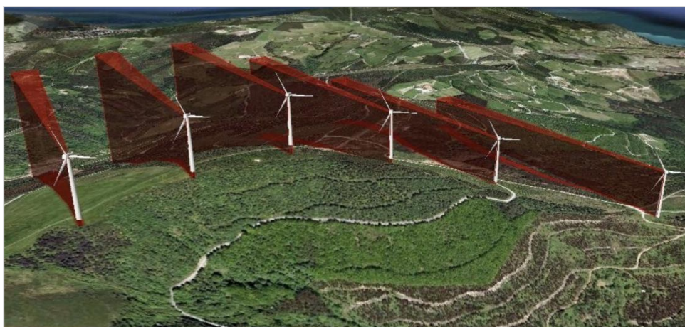
3.11.1. attēls. Aprēķinu piemērs par VES radītu zonu, kurā tiek bloķēts radara stars 212
